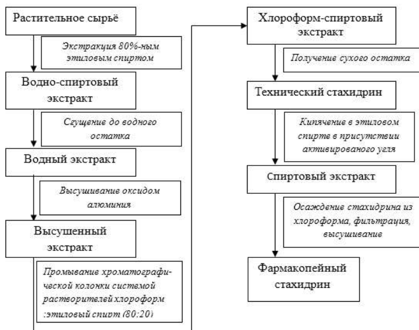
Рисунок 1. Блок-схема получения субстанции алкалоида стахидрина
