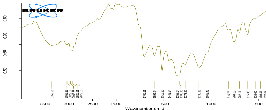
1-rasm. 1-naftalin karbon kislotaning IQ-spektri
