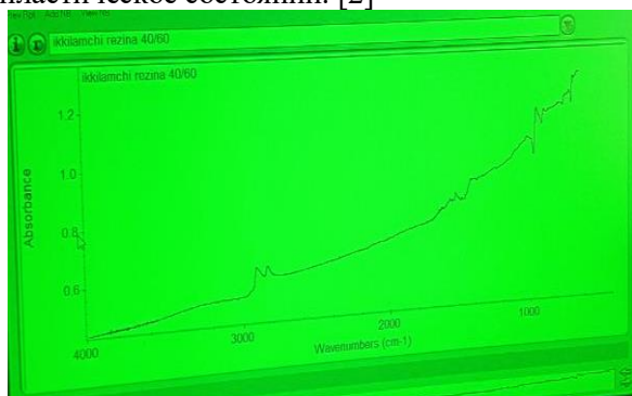
Рис. 1. ИК-спектр вторичной резины по шифру 40/60
