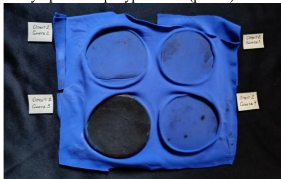
Рис. 2. Эластомерная композиция вулканизируемая в виде шайб дублированная текстильным материалом
