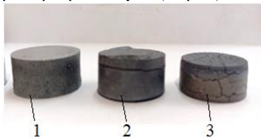
1 – 3 т/см 2 ; 2 – 4 т/см 2 ; 3 – 5 т/см 2 прессланган 2 – расм. Турли босимда прессланган ва қиздириб пиширилган намуналар
