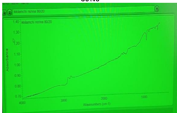
Рис.3. ИК-спектр вторичной резины по шифру 80/20
