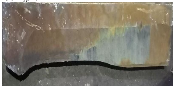
1-rasm. Tashqi kuchlar ta'sirida zoldir prokatlash stani yuqori yo'naltiruvchi lineykasining yeyilgan holati
